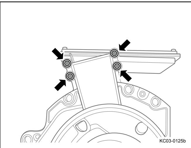
9. 安装并紧固变速器油泵滤芯固定螺栓。
